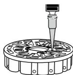
1. Encha o disco aplicando uma pressão ligeira mas constante. A água da amostra irá encher os espaços entre as divisórias no sentido contrário ao dos ponteiros do relógio. Cada espaço se irá encher de baixo para cima. Deverá adicionar-se a água de amostra até esta encher **a la cima** de la quarta câmara, ligeiramente para além da linha de enchimento gravada. Não há problema se encher um pouco mais para além da linha de enchimento.
