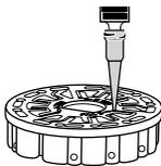
1. Encha qualquer secção não usada do disco aplicando uma pressão ligeira mas constante. Adicione a amostra de água até a câmara vazia se encher e a câmara de transbordamento estar parcialmente cheia.
