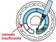
4. No introduzca burbujas de aire en el disco. Las cámaras de reactivos no se llenarán por completo y los resultados no serán precisos. En cuanto se empiece a formar una burbuja, estire del émbolo para extraer la burbuja del disco. Inicie de nuevo el proceso de llenado.
