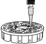
1. Llene las secciones no utilizadas del disco ejerciendo lentamente una ligera presión. Añada la muestra de agua hasta que la Cámara vacía se llene y la Cámara de flujo excesivo se llene parcialmente.
