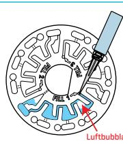
6. Skivorna ska fyllas på och användas inom 10 minuter. De kan inte fyllas framöver.
