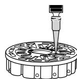
2. Não sobrecarregue o disco. Se o disco estiver cheio demais, a água da amostra fluirá pelo orifício de ventilação no centro do disco. Se isso acontecer, a água da amostra pode fluir para a câmara do reagente prematuramente e os resultados não serão precisos. Comece um novo teste na próxima câmara.
