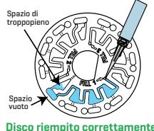
3. Non aggiungere una quantità d'acqua insufficiente. Se il disco non è stato riempito a sufficienza lo spazio riempibile non sarà pieno. Gli spazi contenenti i reagenti non si riempiranno completamente, per cui i risultati mancheranno di precisione.
