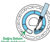
2. Diski aşırı doldurmayın. Disk aşırı doldurulursa su numunesi disk ortasındaki taşıma deliğinden dışarı akacaktır. Disk sizdirmiyor. Diski kurulayın ve testi gerçekleştirin.
