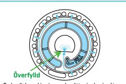
4. Introducera inte luftbubblor i disken. Reagenset kamrarna kommer inte att fylla helt och resultaten kommer att vara felaktiga. Så snart en bubbla börjar bildas, dra tillbaka på kolven för att dra ut bubblan ur disken. Börja fyllningsprocessen igen.
