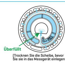
4. Führen Sie keine Luftblasen in die Scheibe ein. Die Reagenz Kammern werden nicht vollständig gefüllt und die Ergebnisse werden ungenau sein. Sobald sich eine Blase zu bilden beginnt, ziehen Sie sich auf den Kolben zurück, um die Blase aus der Scheibe zu ziehen. Beginnen Sie den Füllvorgang wieder.
