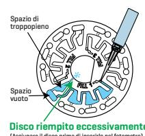
4. Non introdurre bolle d'aria nel disco. Le camere di reagente non si riempiranno completamente e i risultati saranno imprecisi. Non appena una bolla comincia a formarsi, tirare indietro sul pistone per disegnare la bolla fuori del disco. Ricominciare il processo di riempimento.
