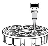
2. No llene demasiado el disco. Si el disco está demasiado lleno, el agua de muestra saldrá por el orificio de ventilación en el centro del disco. Si esto sucede, la muestra de agua puede fluir a una cámara de reactivo prematuramente y los resultados no serán precisos. Comience una nueva prueba en la siguiente cámara.
