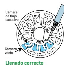
3. No llene el disco por debajo del nivel indicado. Si llena el disco por debajo del nivel adecuado, la cámara vacía no se llenará. Tan pronto como una burbuja comienza a formarse, tire hacia atrás del émbolo para sacar la burbuja del disco. Inicie de nuevo el proceso de llenado.
