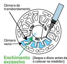
4. Não introduza bolhas de ar no disco. As câmaras de reagente não preencherão totalmente e os resultados serão imprecisos. Assim que uma bolha começa a se formar, puxe para trás no êmbolo para tirar a bolha para fora do disco. Inicie novamente o processo de enchimento.
