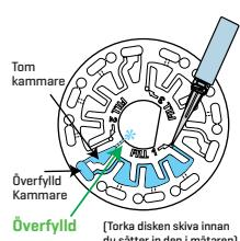
4. Introducera inte luftbubblor i disken. Reagenset kamrarna kommer inte att fylla helt och resultaten kommer att vara felaktiga. Så snart en bubbla börjar bildas, dra tillbaka på kolven för att dra ut bubblan ur disken. Börja fyllningsprocessen igen.
