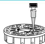
2. Die Scheibe darf nicht überfüllt werden. Wenn die Scheibe überfüllt wird, fließt Probenwasser aus dem Überlaufloch in der Scheibenmitte. Die Scheibe leckt nicht. Trocknen Sie die Scheibe, und führen Sie den Test durch.
