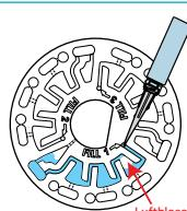
6. Die Scheiben müssen innerhalb von 10 Minuten nach dem Befüllen verwendet werden. Sie können nicht im Voraus befüllt werden.
