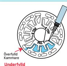
5. Våta skivor ska torkas noggrant med en luddfri trasa. Hantera skivan på kanterna. Mellan testerna lagra skivan på en plan yta. Skaka inte en delvis fyld skiva för att undvika läckage och förorening. Delvis använda skivor ska kasseras vid slutet av dagen.
