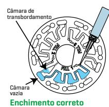
3. Não encha insuficientemente o disco. Se o disco estiver insuficientemente cheio, a câmara vazia não se irá encher. As câmaras do reagente não se irão encher totalmente e os resultados serão inexatos.
