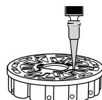
2. Överfyll inte disken. Om skivan är överfyld kommer provvattnet att rinna ut ur ventilationshålet i mitten av skivan. Om detta händer kan provvattnet rinna in i en reagenskammare i förtid och resultaten blir inte korrekta. Börja ett nytt test i nästa kammare.
