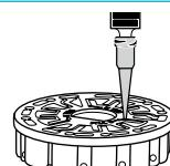
2. Überfüllen Sie die Diskette nicht. Wenn die Scheibe überfüllt ist, fließt Probenwasser aus der Entlüftungsöffnung in der Mitte der Scheibe. In diesem Fall kann Probenwasser vorzeitig in eine Reagenzienkammer fließen und die Ergebnisse sind ungenau. Beginnen Sie einen neuen Test in der nächsten Kammer.
