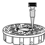
2. Ne remplissez pas trop le disque. Si le disque est trop rempli, l'échantillon d'eau s'écoulera du trou d'aération au centre du disque. Si cela se produit, l'échantillon d'eau peut s'écouler prématurément dans une chambre de réactif et les résultats ne seront pas précis. Commencer un nouveau test dans la chambre suivante.
