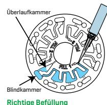
1. Füllen Sie nicht genutzte Scheibenabschnitte mit langsamem, gleichmäßigem Druck. Geben Sie Probenwasser hinzu, bis die Blindkammer gefüllt und die Überlaufkammer teilweise gefüllt ist.
