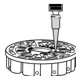
2. Non riempire eccessivamente il disco. Se il disco è troppo pieno, l'acqua campione uscirà dal foro di sfiato al centro del disco. Se ciò accade, l'acqua del campione può fluire prematuramente in una camera del reagente e i risultati non saranno accurati. Inizia un nuovo test nella prossima camera.
