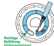
3. Füllen Sie nicht zu wenig Wasser in die Scheibe. Wenn zu wenig Wasser eingefüllt wird, füllen sich die Reagenskammern nicht vollständig, und die Ergebnisse werden ungenau.
