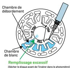
4. Ne créez aucune bulle d'air dans le disque. Les chambres de réactifs ne seront pas entièrement remplies et les résultats seront inexacts. Dès qu'une bulle commence à se former, tirez sur le piston pour tirer la bulle du disque. Recommencez le processus de remplissage.
