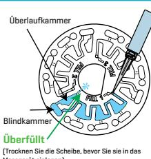
4. Führen Sie keine Luftblasen in die Scheibe ein. Die Reagenskammern füllen sich nicht vollständig, und die Ergebnisse werden ungenau. Entnehmen Sie das Probenwasser mit der Spritze, und befüllen Sie die Scheibe erneut.
