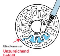
3. Führen Sie keine Luftblasen in die Scheibe ein. Die Reagenz Kammern werden nicht vollständig gefüllt und die Ergebnisse werden ungenau sein. Sobald sich eine Blase zu bilden beginnt, ziehen Sie sich auf den Kolben zurück, um die Blase aus der Scheibe zu ziehen. Beginnen Sie den Füllvorgang wieder.
