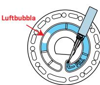
6. Skivorna ska fyllas på och användas inom 10 minuter. De kan inte fyllas framöver.
