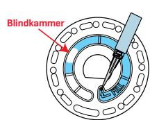
6. Die Scheiben müssen innerhalb von 10 Minuten nach dem Befüllen verwendet werden. Sie können nicht im Voraus befüllt werden.
